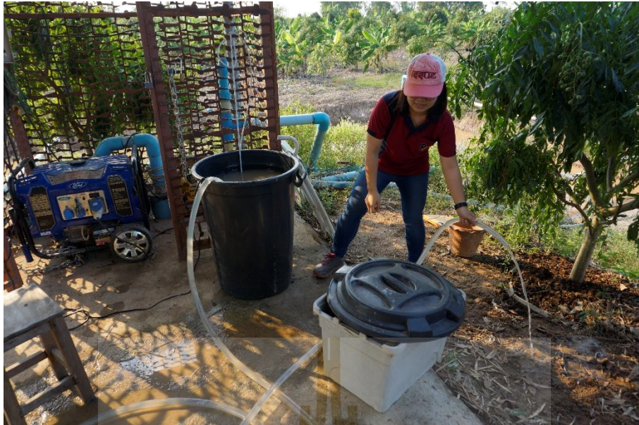
รูปที่ 3.14 ทดสอบปั๊มจุ่มขนาดพิกัด 1 แรงม้า
