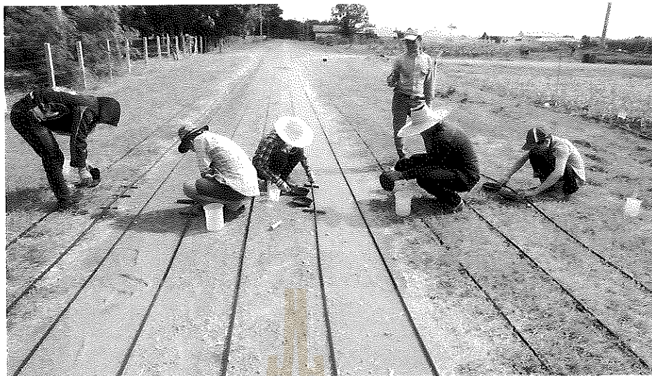
ภาพผนวกที่ 3 การทดสอบความสม่ำเสมอการกระจายน้ำ
