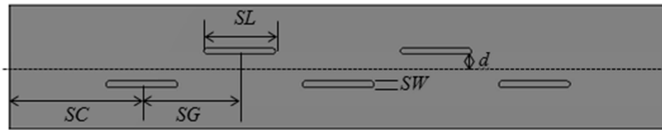
รูปที่ 3.88 พารามิเตอร์ของสายอากาศแบบร่องบนท่อนำคลื่นจำนวน 5 ร่อง
