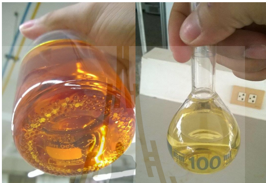
รูปที่ 3.10 การตกตะกอนของน้ำมันไบโอดีเซล
