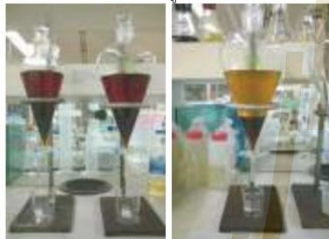
รูปที่ 3 การแยกชั้นของน้ำมันไบโอดีเซลและ Glycerol โดยที่น้ำมันไบโอดีเซลจะลอยขึ้นบนเหนือ Glycerol (ขวามือ) น้ำมันไบโอดีเซลจากน้ำมันปาล์มดิบ (ซ้ายมือ) น้ำมันไบโอดีเซลจากน้ำมันทำอาหารที่ใช้แล้ว
