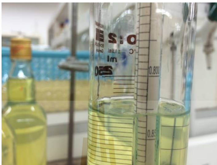
รูปที่ 3.13 การจุ่มไฮโดรมิเตอร์ลงในกระบอกตวง
