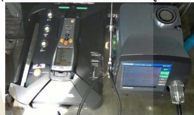
รูปที่ 11 (ขวามือ) เครื่องมือวัดมลพิษยี่ห้อ Testo รุ่น 350 (ซ้ายมือ) เครื่องมือวัดมลพิษยี่ห้อ Horiba รุ่น Mexa-584L
