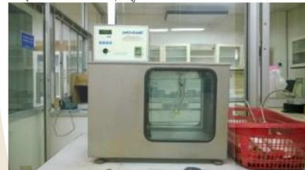
รูปที่ 5 เครื่องมือ Viscosity Kinematic Capillary Tempering Bath High Temperature และการวัดความหนืดภายใต้มาตรฐาน ASTM D445
