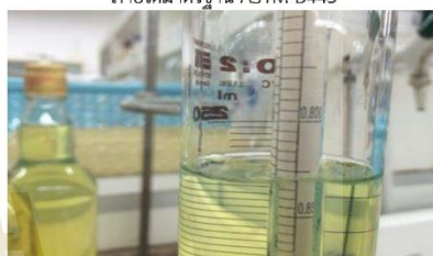
รูปที่ 6 การวัดค่าความถ่วงจำเพาะด้วยไฮโดรมิเตอร์ (Hydrometer) ภายใต้มาตรฐาน ASTM D1298
