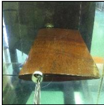
รูปที่ 3.19 แบบจำลองแพนอากาศรุ่น NACA0012
