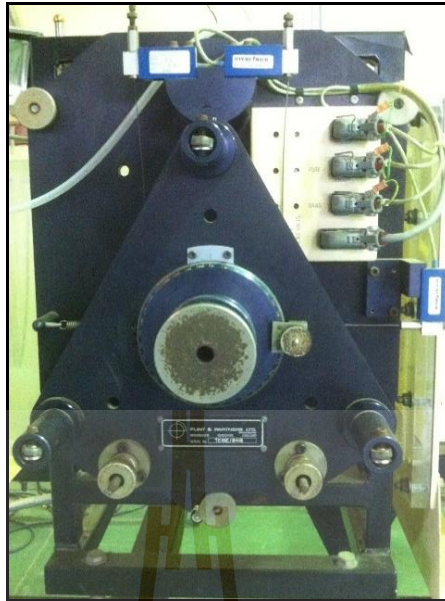
รูปที่ 3.15 อุปกรณ์วัดแรงต้านและแรงอื่น ๆ
