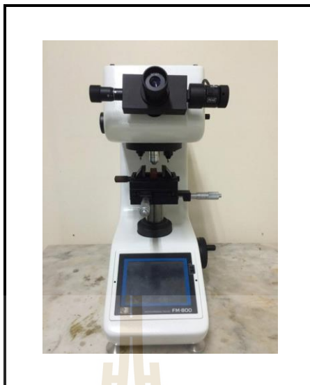
รูปที่ 3.13 เครื่อง Micro Vickers Hardness Testing ของ Future-Tech
