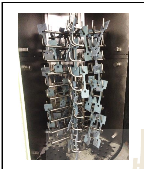
รูปที่ 3.3 ลักษณะการเรียงชิ้นทดสอบภายใน เครื่องยิงเม็ดโลหะ
