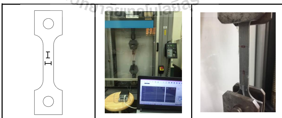
รูปที่ 3.15 ชั้นทดสอบและอุปกรณ์การติดตั้ง Strain Gauge กับชั้นทดสอบบนเครื่องทดสอบแรงดึง
