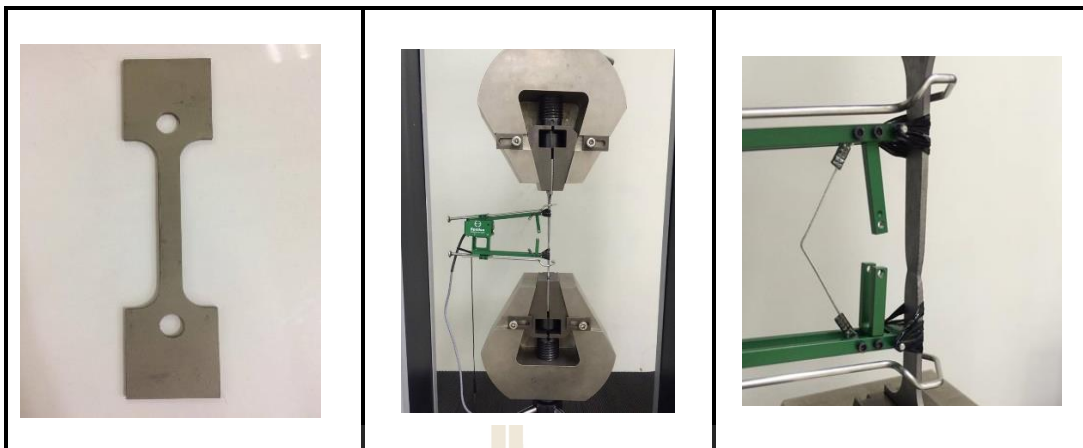
รูปที่ 3.14 ชั้นทดสอบและการติดตั้งอุปกรณ์ Extensometer กับชั้นทดสอบบนเครื่องทดสอบแรงดึง
