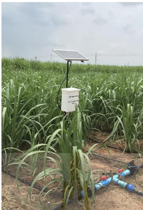
รูปที่ 4.4 การติดตั้งเครือข่ายเซ็นเซอร์ไร้สายในพื้นที่แปลงทดลองการปลูกอ้อยระบบน้ำหยด
