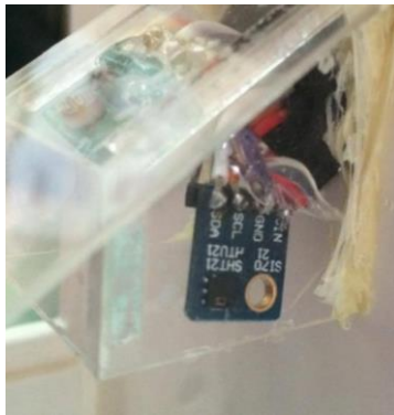
รูปที่ 4.10 เซ็นเซอร์ตรวจวัดอุณหภูมิและความชื้นสัมพัทธ์ในอากาศ
