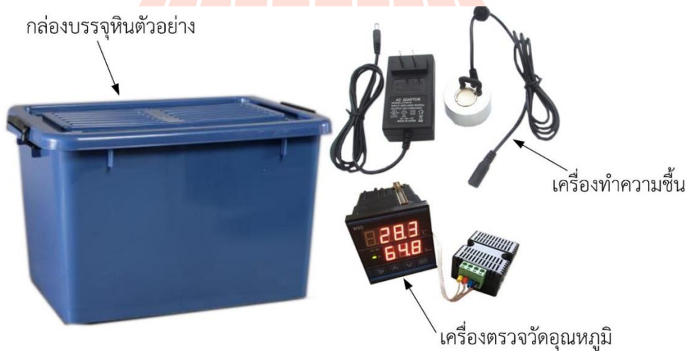
รูปที่ 4.8 อุปกรณ์การตรวจวัดความชื้น
