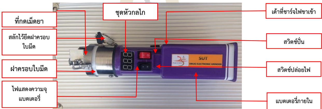
ภาพที่ 1 แสดงส่วนประกอบของเครื่องบดยาไฟฟ้า
