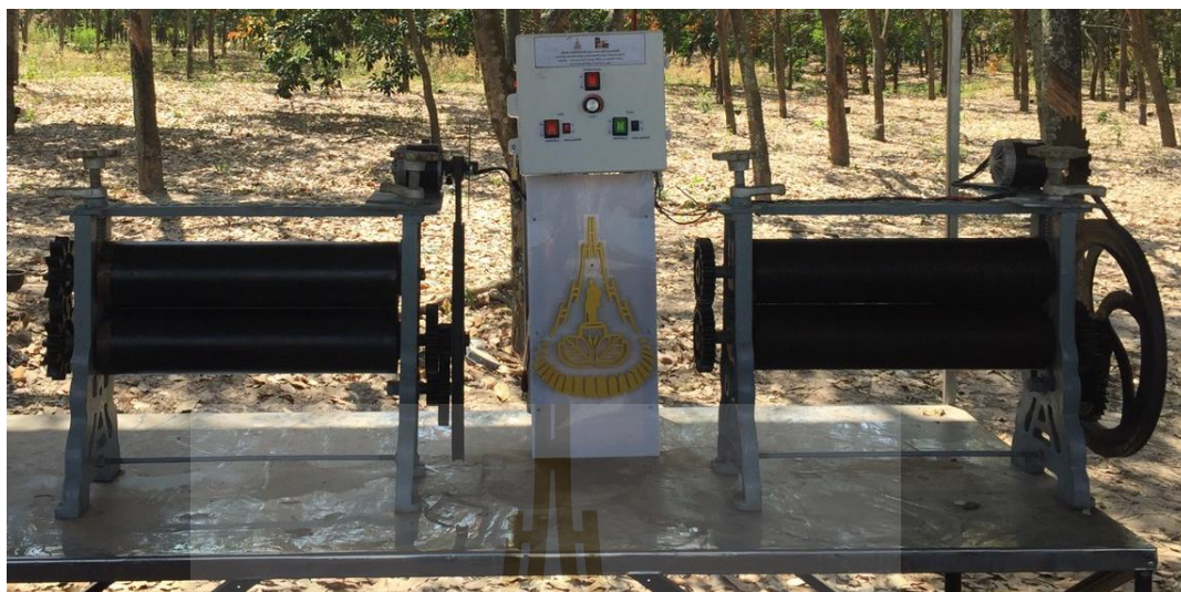
รูปที่ จ.1 เครื่องรีดยางพาราไฟฟ้าอัจฉริยะที่ควบคุมความหนาแผ่นยางพาราแบบอัตโนมัติ
