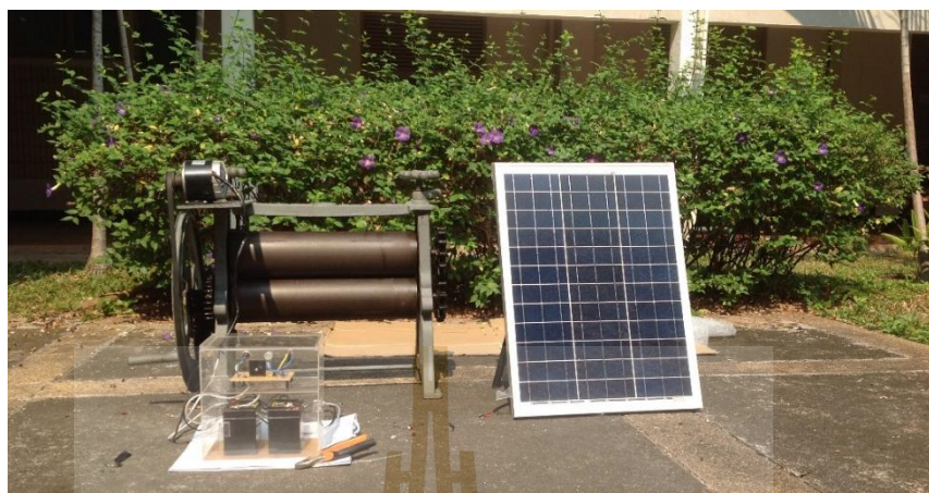
รูปที่ 1.3 เครื่องรีดยางพาราไฟฟ้าที่ใช้พลังงานจากเซลล์แสงอาทิตย์
