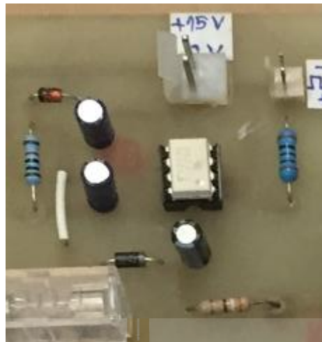
รูปที่ 3.25 วงจรแยกโศดสัญญาณที่ใช้งานจริง
