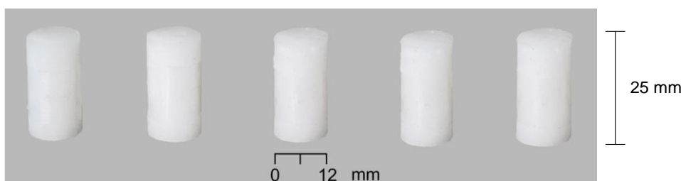
รูปที่ 3.1 ตัวอย่างวัสดุจำลองชั้นหินปิดทับที่ใช้ในการทดสอบกำลังรับแรงกดในแกนเดียว
