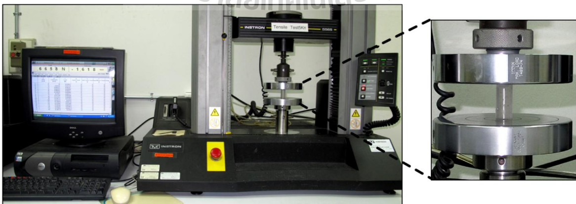
รูปที่ 3.2 การทดสอบกำลังรับแรงกดในแกนเดียว
