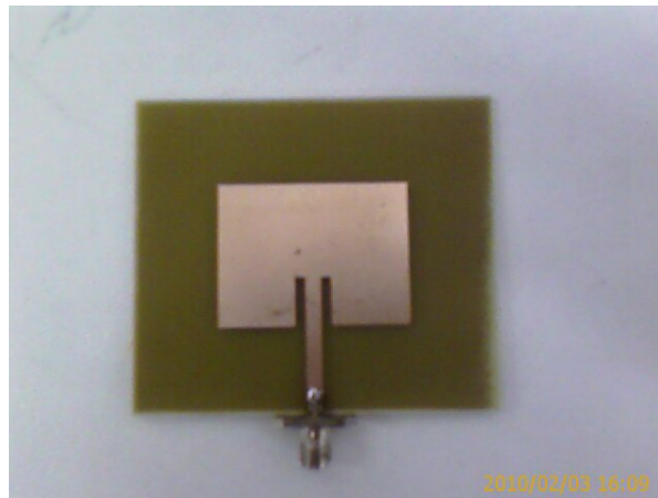
รูปที่ 4.5 รูปการนำเอาสายอากาศแบบแพตช์ (Patch) ไปต่อที่หัวเชื่อมต่อ Z_0 = 50\Omega เข้าที่จุดป้อนสัญญาณ ที่เรียบร้อยแล้ว
