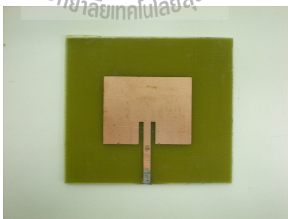
รูปที่ 4.4 สายอากาศแบบแพทช์ที่ต้องการ หลังจากกัดส่วนที่ไม่ต้องการออกแล้ว
