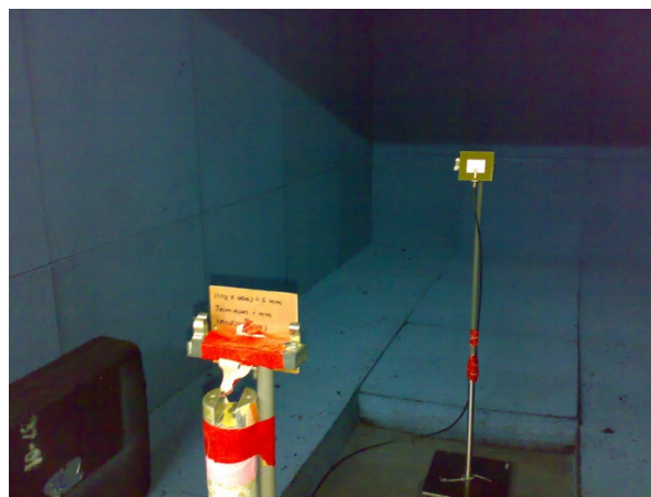
รูปที่ 4.10 การวัดการแผ่กระจายกำลังงานในห้องแชมเบอร์
