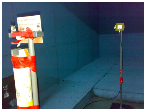
รูปที่ 4.9 การวัดอัตราขยายของสายอากาศในห้องแชนเบอร์
