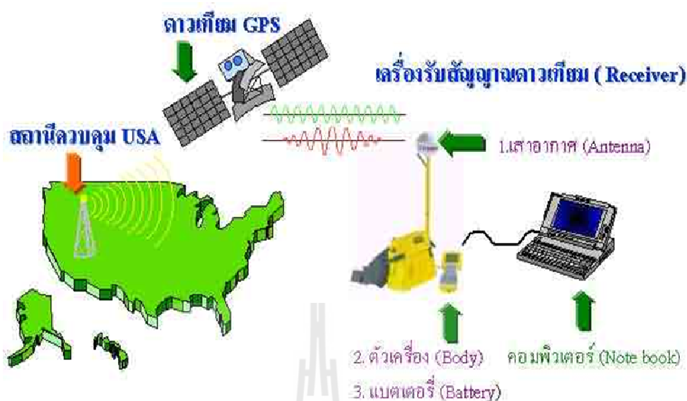
รูปที่ 2.2 ส่วนประกอบของระบบดาวเทียม GPS
