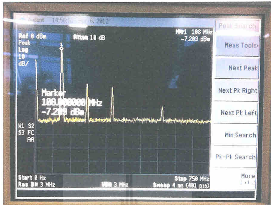
รูปที่ 5.26 ลักษณะของสัญญาณเอาต์พุตที่กำลังของสัญญาณอินพุตสูงสุดใน Spectrum analyzer ที่ความถี่ 108 เมกะเฮิร์ตซ์
