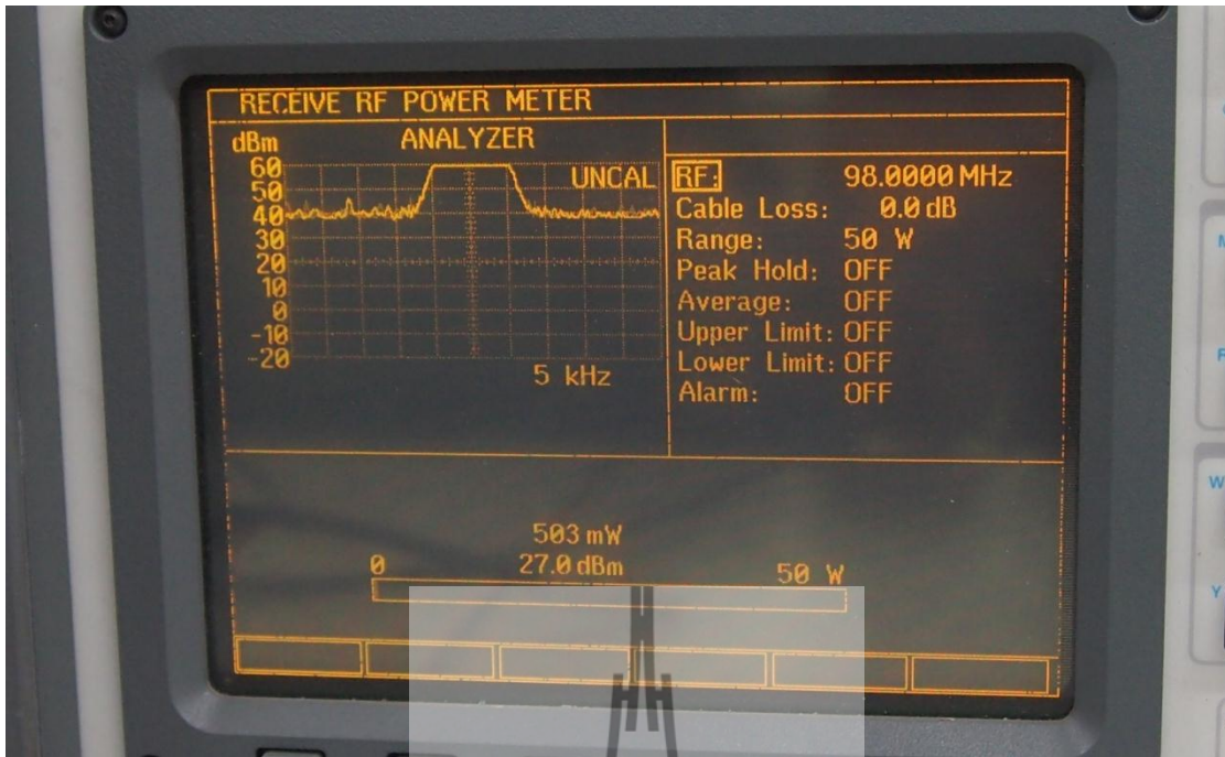
รูปที่ 4.2 สัญญาณอินพุตวงจรถบายสัญญาณชุดที่ 1 ที่ความถี่ 98 เมกะเฮิรตซ์
