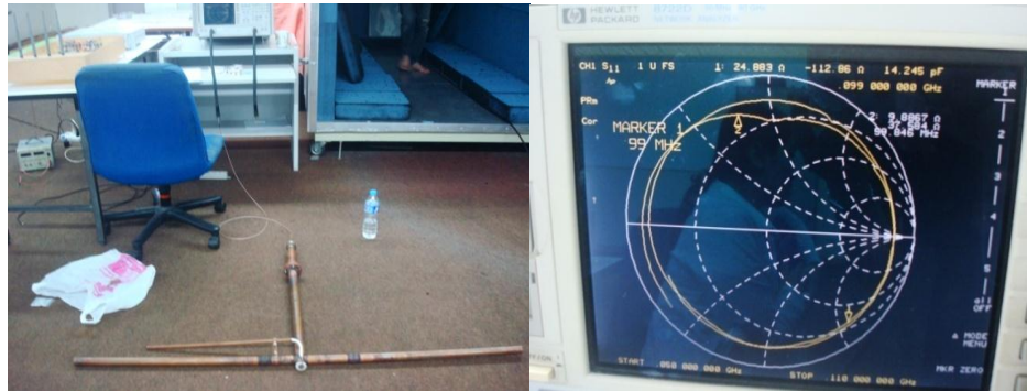
รูปที่ 4.9 การวัดอิมพีแดนซ์ของสายอากาศไดโพล
