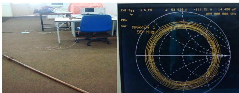
รูปที่ 4.6 การวัดอิมพีแดนซ์ของสายนำสัญญาณ
