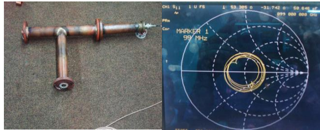
(ก) พอร์ต 1 อิมพีแดนซ์เท่ากับ 53.305 โอห์ม
