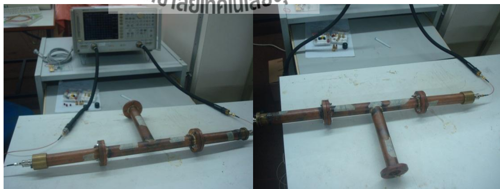
รูปที่ 4.17 การวัดค่าการสูญเสียจากการใส่แทรก ( S_{21} ) ของ T-connector ตัวที่ 1 และ 2
