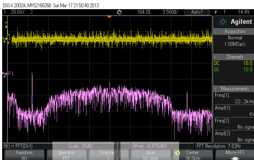
รูปที่ 4.16 ป้อนสัญญาณ Color Noise ที่วงจร Stereo Encoder โดยที่ Center ที่ 38 kHz
