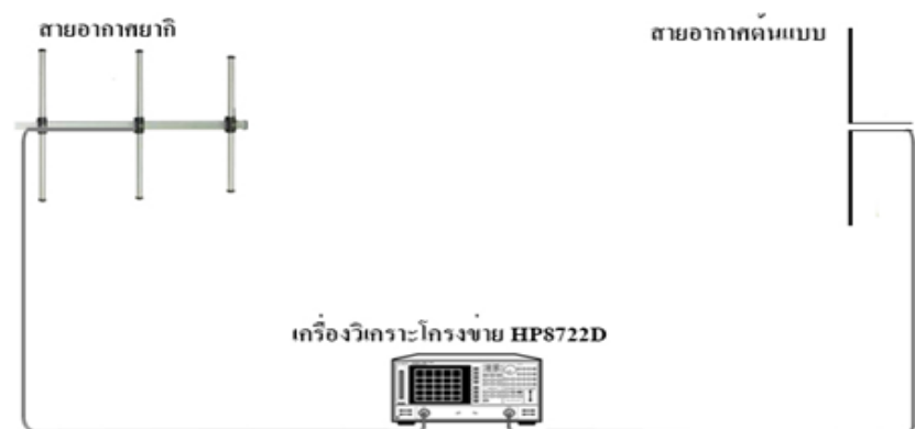
รูปที่ 4.15 แบบจำลองการวัดระนาบสนามแม่เหล็ก
