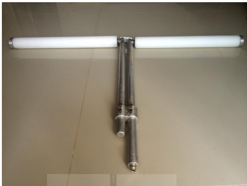
รูปที่ 4.3 แมตซ์ซิ่งของสายอากาศไดโพลเส้นตรงความยาวครึ่งคลื่น ( \lambda/2 Straight dipole) ที่มีความยาวน้อยกว่าสายอากาศไดโพลทั่วไป แต่ยังรักษาคุณสมบัติของสายอากาศชนิดนี้
