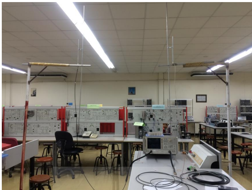
รูปที่ 4.20 การวัดอัตราขยายของสายอากาศไดโพล 2 ตัว ที่มีลักษณะเหมือนกัน ซึ่งเครื่อง Network Analyzer จะอ่านค่า P_r ได้เท่ากับ -21.234 dB แสดงดังรูปที่ 4.21
