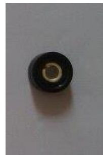
(ค) เลนส์เพื่อการทดสอบ ความยาวโฟกัส 10 mm
