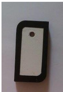
(ข) กล้องจุลทรรศน์พกพา ความยาวโฟกัส 8 mm
