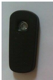
(ก) Keeploopmicroscope ความยาวโฟกัส 5 mm
