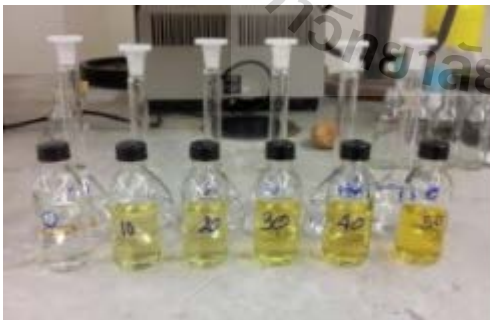
การทำ Colorimetric method เพื่อหาค่าของเปอร์ซัลเฟต
