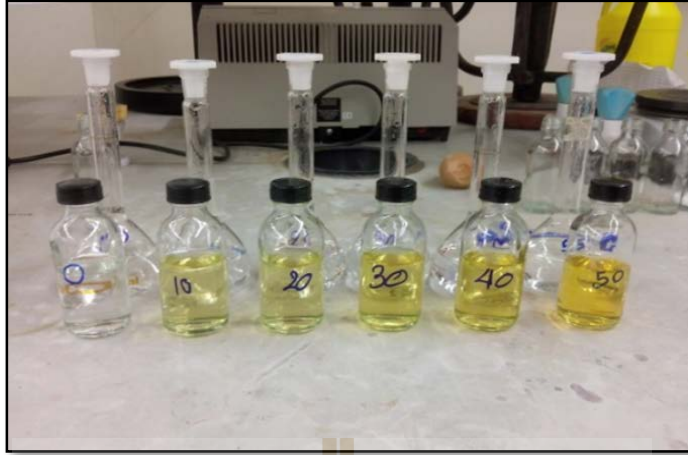
ภาพที่ 7 แสดงการทำ Standard Curve ของเปอร์ซิลเฟต
