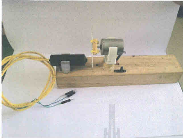
รูปที่ 3.5 นำเซนเซอร์ติดตั้งบนแท่นทดลองเพื่อวัดรอบ
