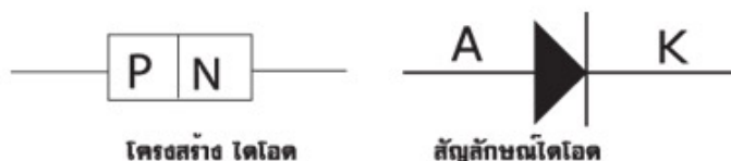
รูปที่ 2.5.4 โครงสร้างไดโอดและสัญลักษณ์ไดโอด[7]
