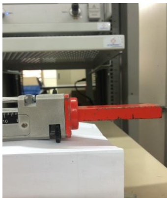
รูปที่ 3.11 การประกอบตัวโพลีคลายทอเข้าที่ปลายเปิดของสล็อตไลน์
