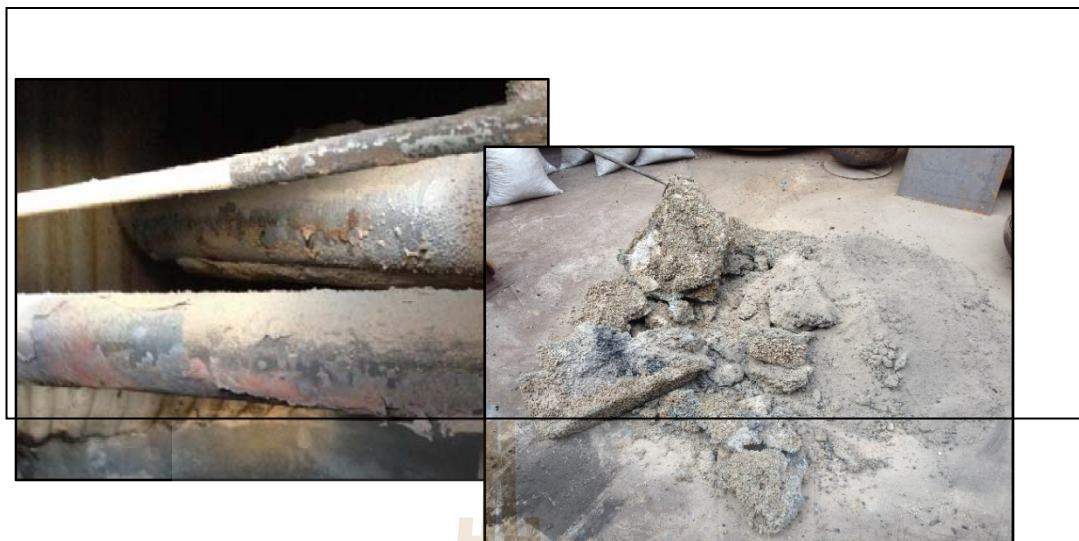
รูปที่ 4.17 อุปกรณ์การเผาถ่านลอยภายนอกท่อที่ทำทดสอบ(ซ้าย) ลักษณะของถ่านที่หลอมตัวภายในเตาของถ่านหนัก(Bottom Ash)
