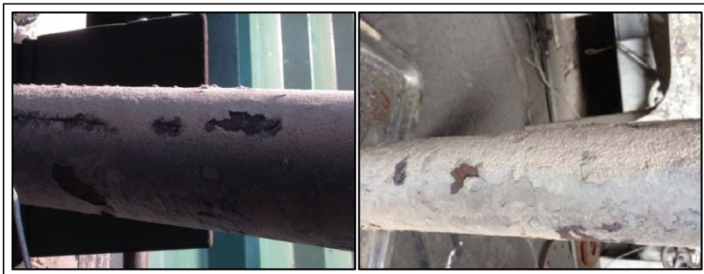
รูปที่ 4.44 ลักษณะถ้ำลอยและออกไซด์ที่ทำปฏิกิริยาเมื่อใช้เชื้อเพลิงผสมดินอัตรา 5% โดยน้ำหนัก
