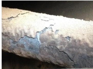
รูปที่ 3 ลักษณะของออกไซด์ของเตาทำปฏิกิริยาท่อน้ำ
