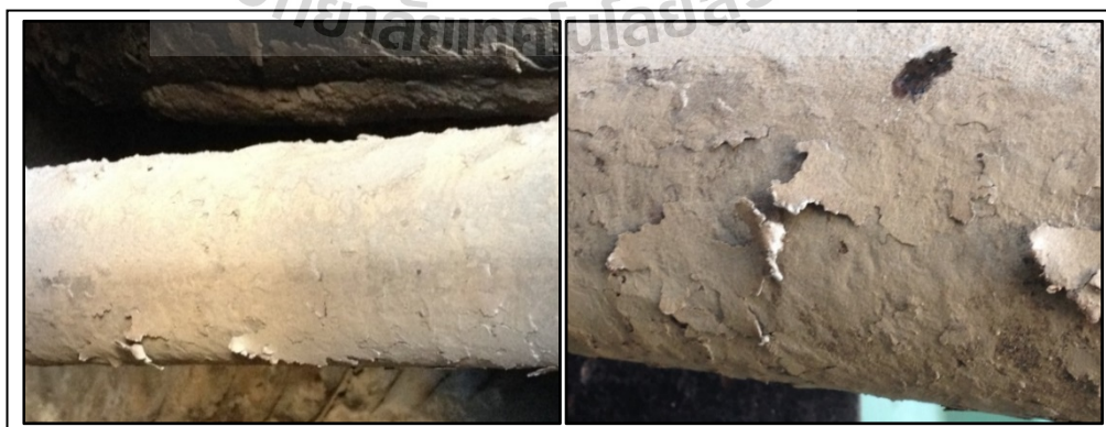
รูปที่ 4.46 ลักษณะถ้ำลอยและออกไซด์ที่ทำปฏิกิริยาเมื่อใช้เชื้อเพลิงผสมดินอัตรา 12% โดยน้ำหนัก
