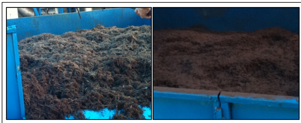
รูปที่ 4.9 แสดงเปลือกไม้ยูคาลิปตัสก่อนและหลังการสับด้วยเครื่อง Hammer Mill
