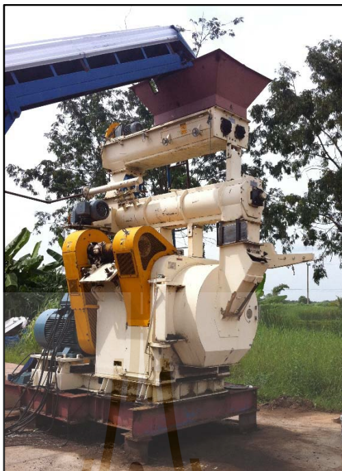
รูปที่ 3.4 ลักษณะของเครื่องอัดแท่งชีวมวล(Pelletizing Machine)
