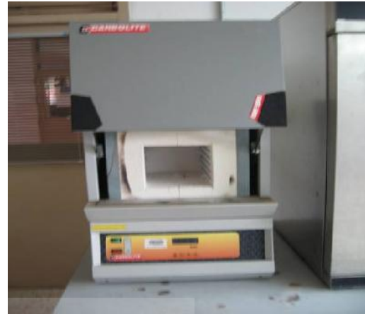
ข. เตาเผา Muffle Furnace (วิเคราะห์ปริมาณเถ้า และสารระเหย)
