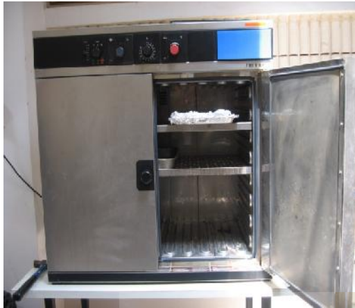
ก. เตาอบ Drying Oven (วิเคราะห์ความชื้น)
