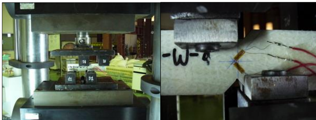
รูปที่ ก.37 การติดตั้งตัวอย่างสำหรับการทดสอบแรงเหวี่ยงตามแนวแกนของเส้นใย
