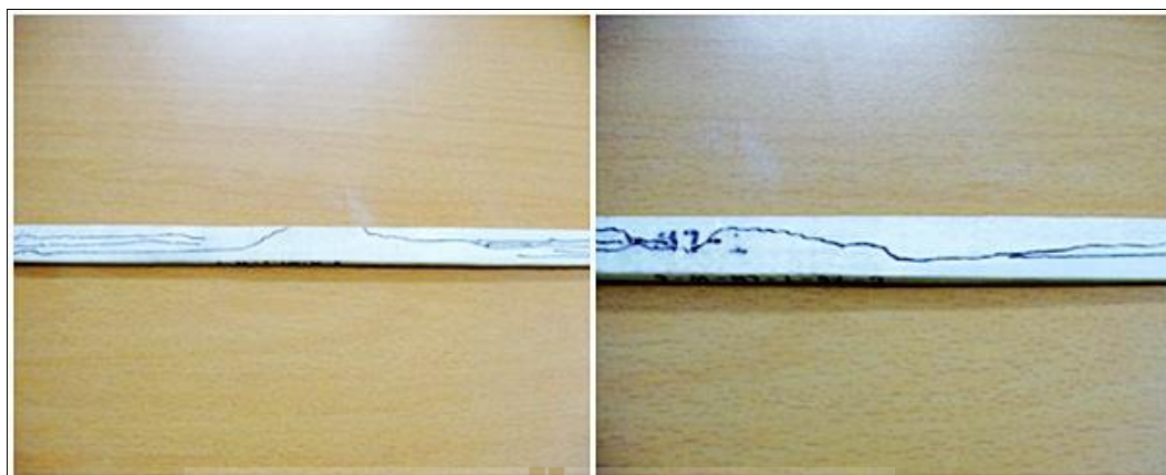
รูปที่ ก.17 การวิบัติของตัวอย่างทดสอบแรงดึงตามแนวแกนของเส้นใย
