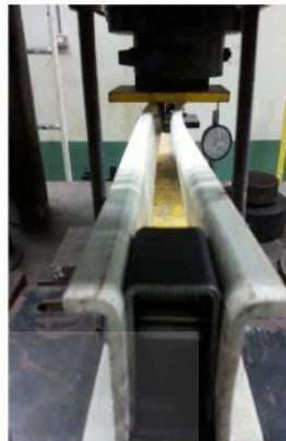
รูปที่ 12 การวิบัติของตัวอย่างทดสอบแบบโก่งคดทางด้านข้าง
