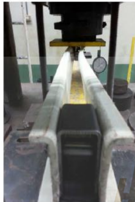
รูปที่ 8 การวิบัติของตัวอย่างแบบโค้งเดาะทางด้านข้าง
