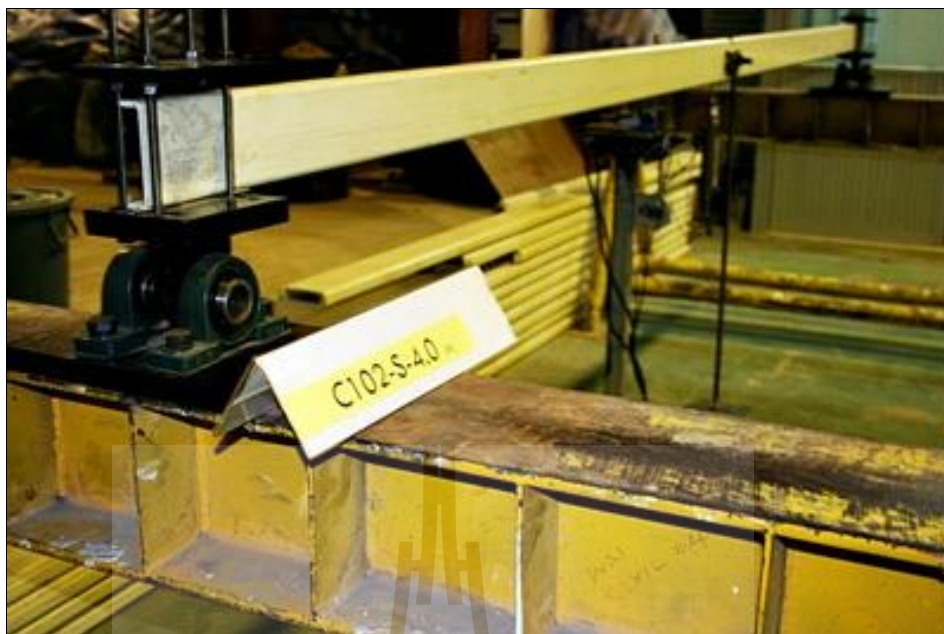
รูปที่ ข.3 การติดตั้งตัวอย่างทดสอบเข้ากับจุดรองรับแบบง่าย
