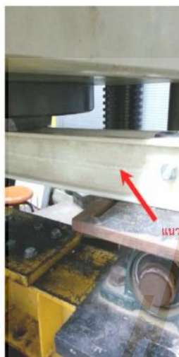
รูปที่ 11 การวิบัติของตัวอย่างทดสอบเนื่องจากแรงเฉือนตามขวาง
