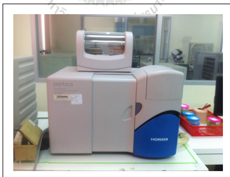
รูปที่ 3.12 เครื่องวิเคราะห์การกระจายขนาดของอนุภาค
