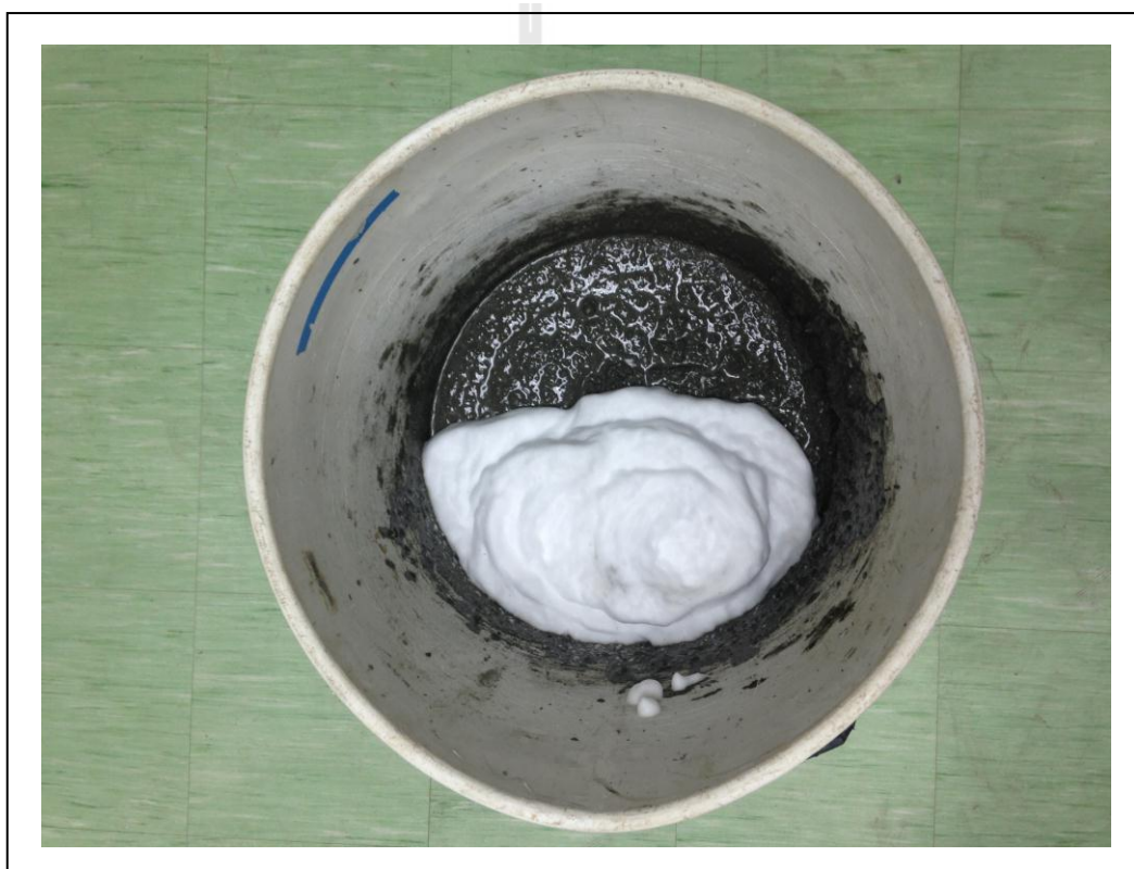
รูปที่ 3.18 การผสมโฟมในคอนกรีตมวลเบาแบบ pre-formed foam method
