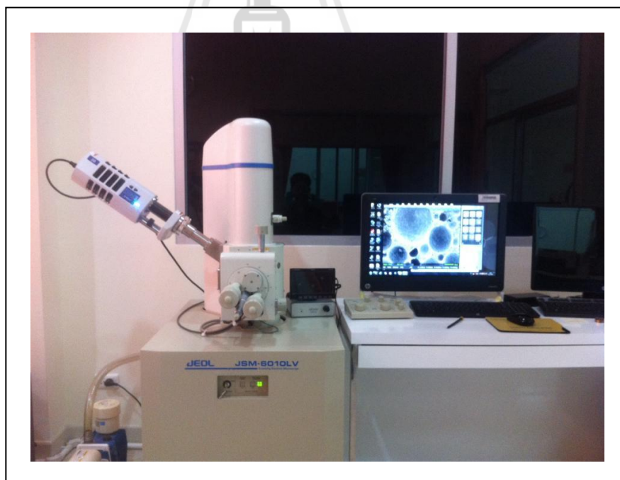
รูปที่ 3.16 กล้องจุลทรรศน์อิเล็กตรอนแบบส่องกราด (SEM)
