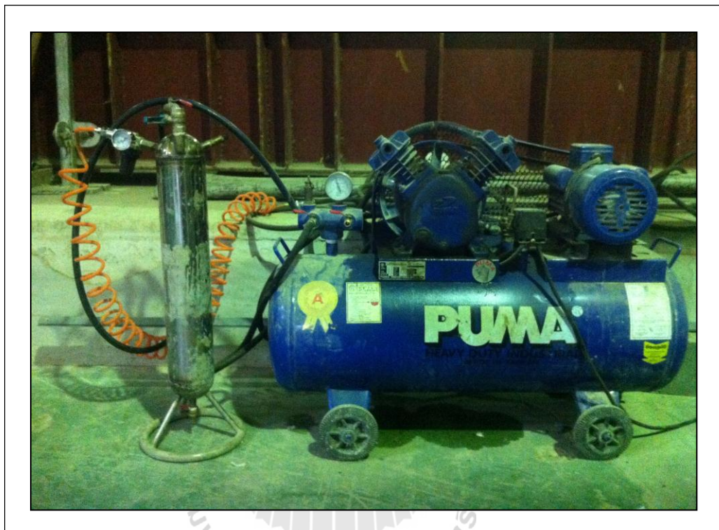
รูปที่ 3.5 เครื่องอัดอากาศที่ต่อเข้ากับเครื่องกำเนิดโฟม
