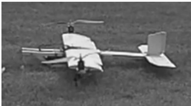
รูปที่ 3.40 โครงสร้างปีกที่สร้างเสร็จและนำมาประกอบกับอากาศยานเรียบร้อย
