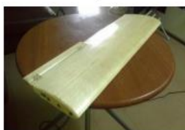
รูปที่ 21 โครงสร้างปีกแบบ Clark Y 11.7% Smoothed ส่วนที่ตัดออกจากชุดมอเตอร์
