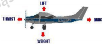
รูปที่ 6 แรงกระทำในของอากาศยานปีกตรึง [2]
