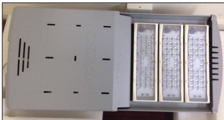
รูปที่ 6.1 โคมไฟถนนแอลอีดีที่ใช้ในการทดสอบจริงขณะยังไม่จ่ายไฟ
