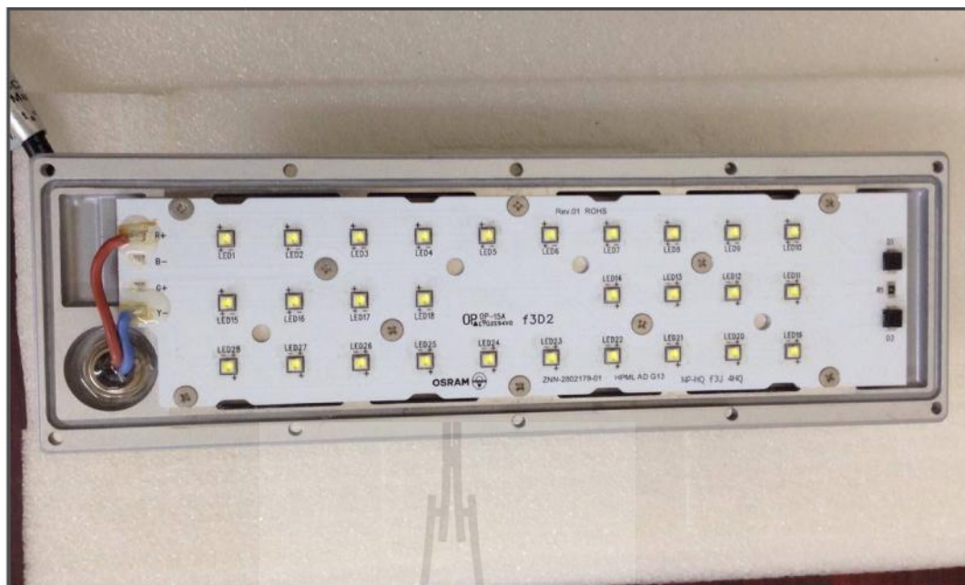
รูปที่ 6.5 แผงวงจรของแอลอีดีโมดูล เมื่อถอดฝาเลนส์ออก
