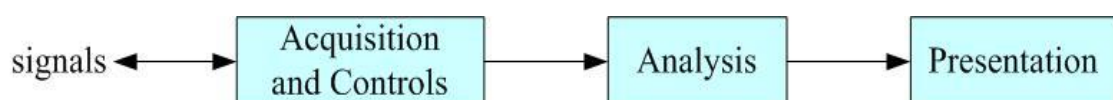
รูปที่ 2.21 Block Diagram เครื่องมือวัดที่สร้างจาก LabVIEW
