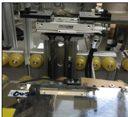
รูปที่ 3.12 แสดงตัวจับชิ้นงานรอการถ่ายภาพ
