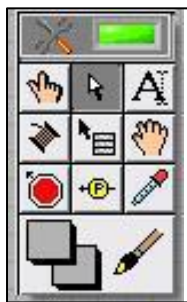
รูปที่ 2.32 แสดง Tools Palette ที่ใช้ในการออกแบบ Front Panel
