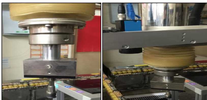
รูปที่ 3.8 แสดงการติดตั้งหัว Vacuum
