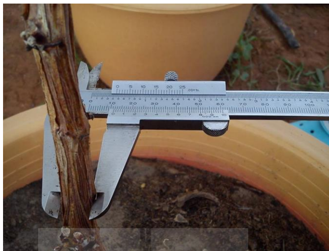
รูปภาพหมวดที่ 3 วัดขนาดเส้นผ่านศูนย์กลางลำต้น ด้วยเวอร์เนียคาลิเปอร์
