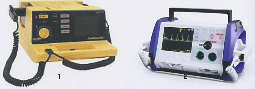
รูปที่ 17 แสดงเครื่องช็อกไฟฟ้าแบบ monophasic (1) และแบบ biphasic (2)
