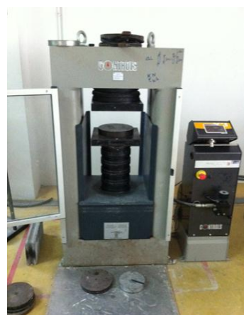
รูปที่ 3.10 เครื่องทดสอบกำลังอัดของคอนกรีต
