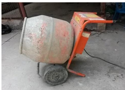
รูปที่ 3.9 เครื่องผสมคอนกรีต
