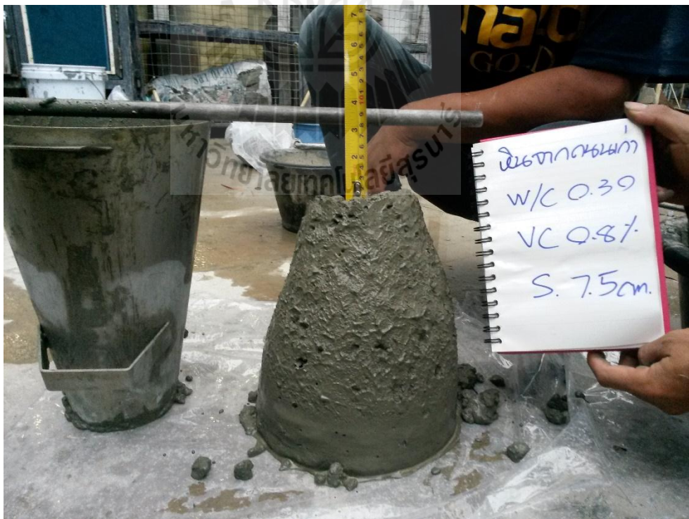
รูปที่ ค.7 ภาพการทดสอบความขุบตัวของคอนกรีตสดที่ใส่น้ำยาลดน้ำร้อยละ 0.8 ที่ W/C = 0.30
