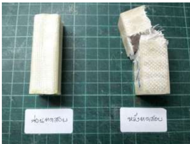
รูปที่ 4.5 ไม้เนื้อแข็งคอมโพสิตที่พันด้วยเส้นใยแก้ว 9 รอบก่อนและหลังการทดสอบแรงอัด (Compression Test)
