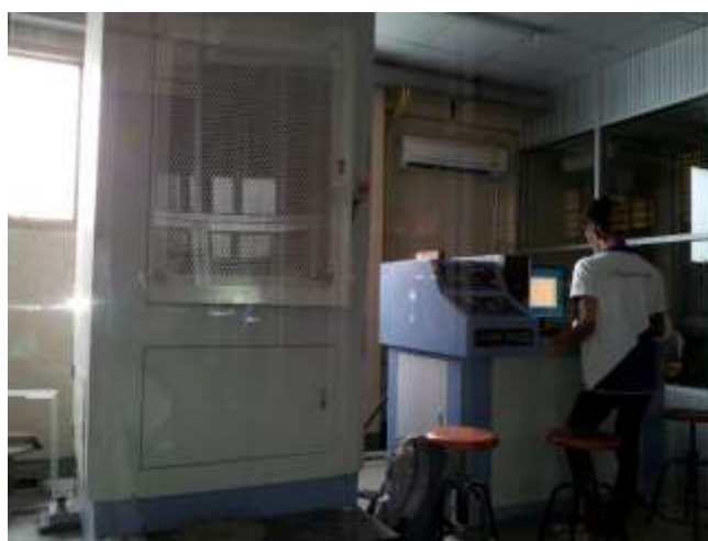
รูปที่ 2.11 เครื่องทดลองเพื่อหาค่าสมบัติทางกลของไม้หรือวัสดุอื่น ๆ
