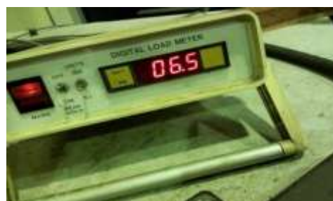
รูปที่ 3.13 เครื่อง Load Meter ทดสอบแรงดัด
