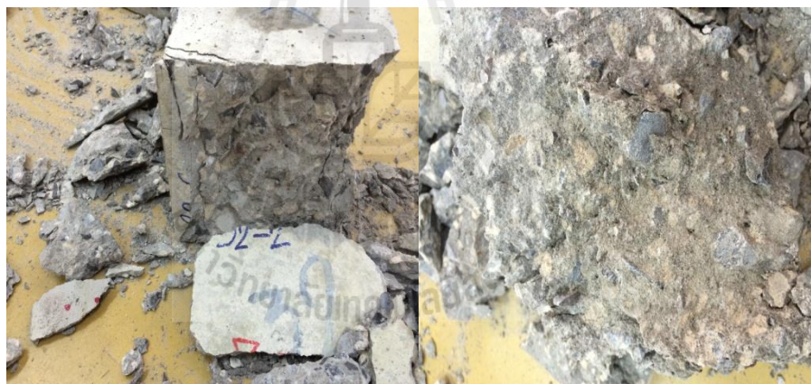
รูปที่ 4.10 การวิบัติของก้อนตัวอย่าง(0.5F10) ที่อัตราส่วนน้ำต่อวัสดุประสานเท่ากับ 0.5
