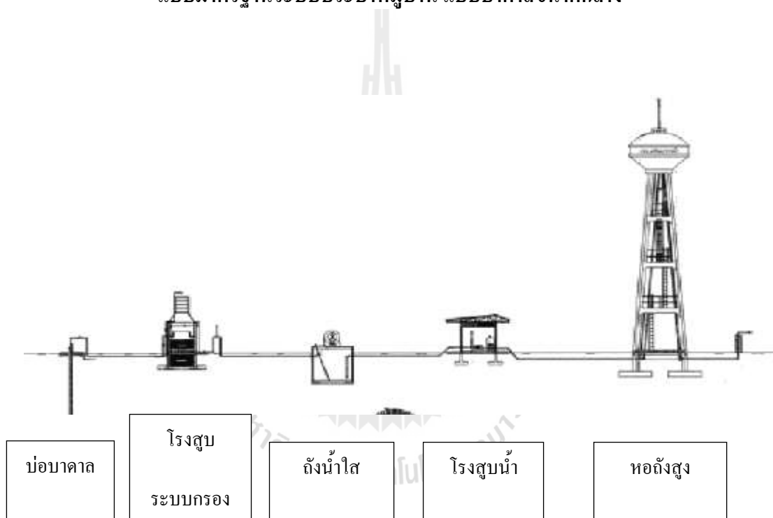
รูปที่ 2.7 แบบมาตรฐานประปาหมู่บ้าน แบบบาดาลขนาดกลาง กำลังการผลิต 7 ลบ.ม/ชม.
