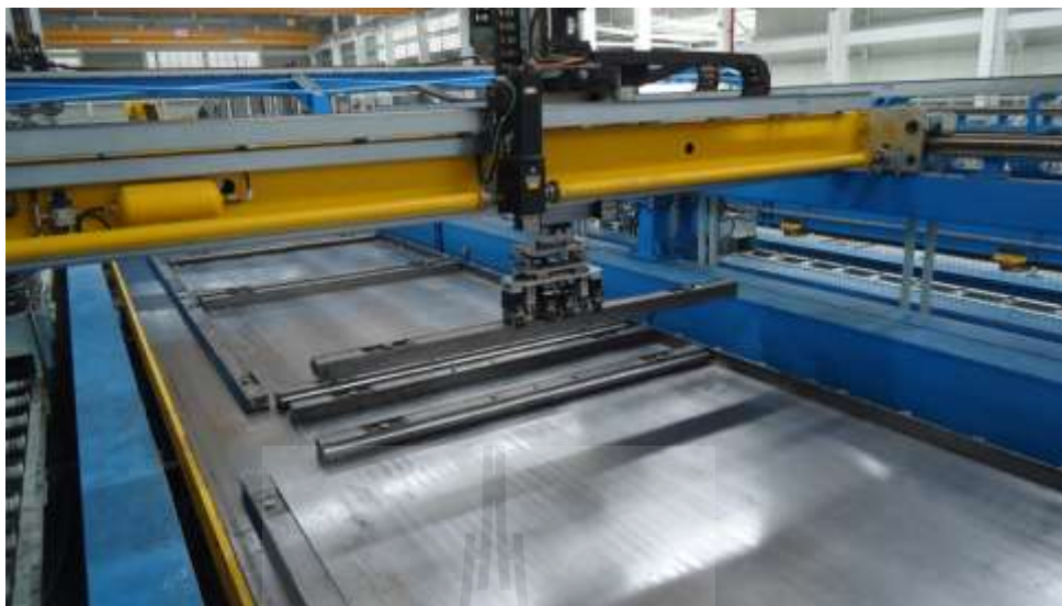
รูปที่ 2.5 การวางเหล็กกั้นแบบ (Pruksa Real Estate, 2015)
