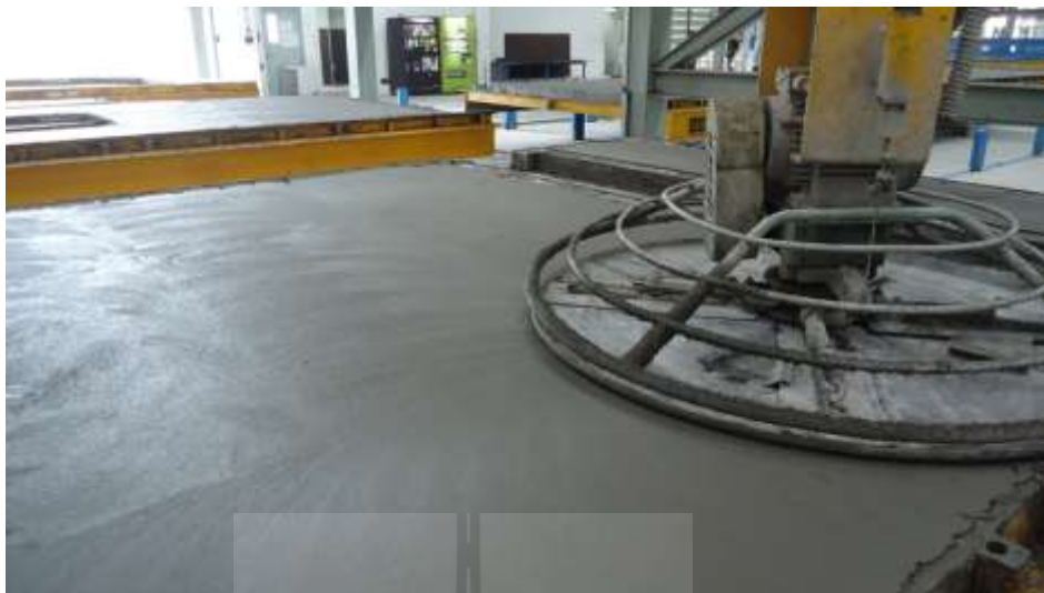
รูปที่ 2.9 การขัดผิวหน้าคอนกรีต (Pruksa Real Estate, 2015)
