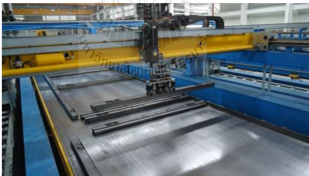
รูปที่ 2.4 การวางเหล็กกันแบบ (Pruksa Real Estate , 2015)
