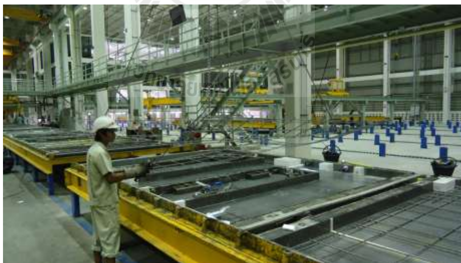
รูปที่ 2.6 การวางเหล็กเสริม (Pruksa Real Estate , 2015)
