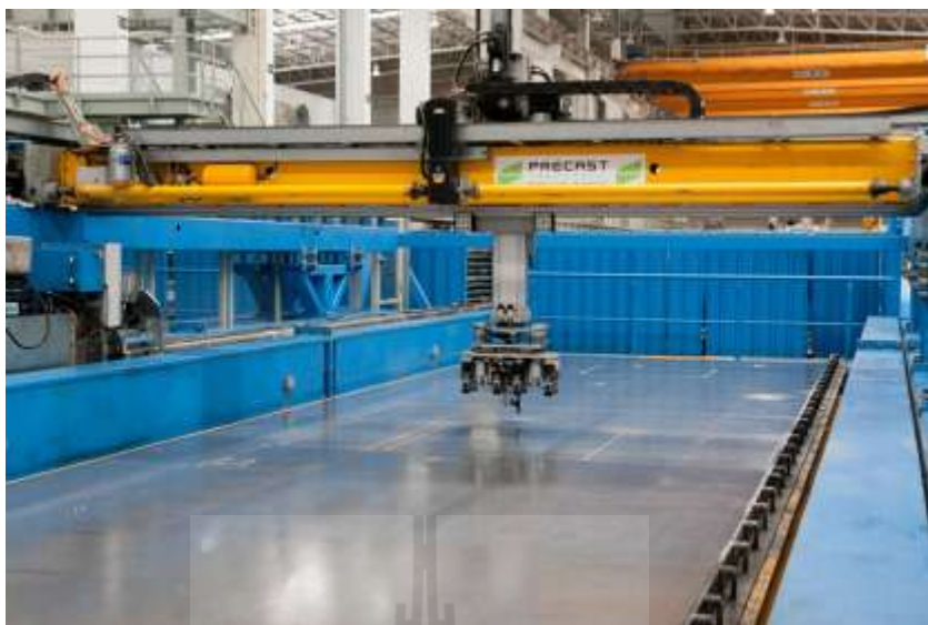
รูปที่ 2.3 การวางตำแหน่งอุปกรณ์ และของฝัง (Pruksa Real Estate, 2015)
