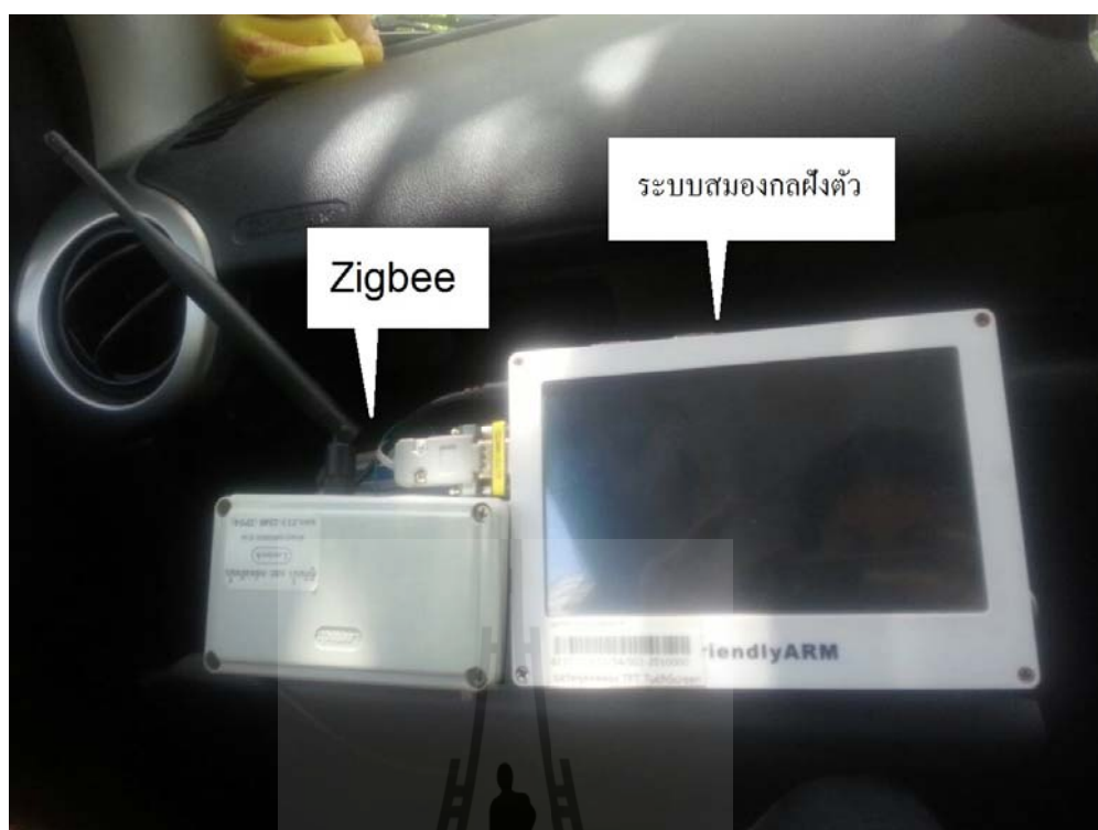
รูปที่ 4.64 ระบบสมองกลฝังตัวที่ต่อเข้ากับอุปกรณ์ของเครือข่ายไร้สาย Zigbee
