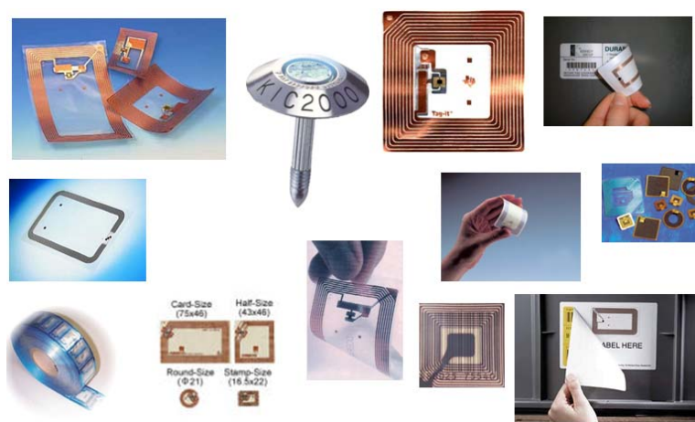
รูปที่ 2.3 แท็ก RFID ในรูปแบบต่าง ๆ [www.jesic-tech.com]
