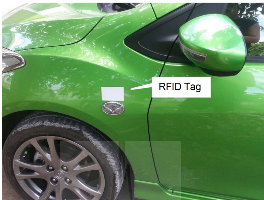
รูปที่ 4.69 แท็กส์ที่ติดตั้งอยู่กับรถยนต์ที่ใช้ในการตรวจสอบ
