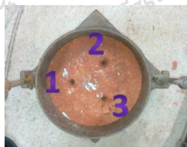
รูปที่ 3.3 ตำแหน่งการทำ PCP test ใน โมลดินบดอัด
