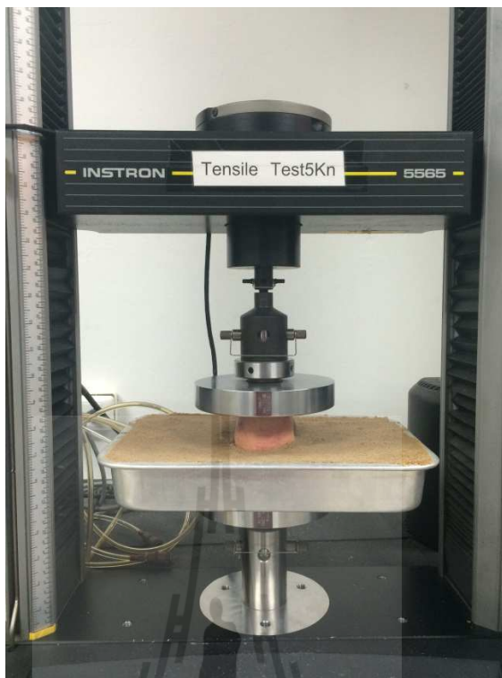
รูปที่ 3.9 การทดสอบการกดทับ โดยใช้เครื่อง Universal Testing Machine (UTM)
