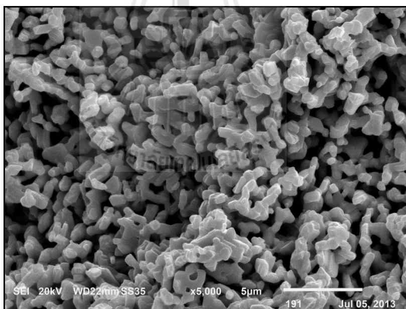
รูปที่ 4.22 โครงสร้างจุลภาคของ \text{La}_5\text{Ni}_4\text{O}_{13} ( n = 4 ) และเฟาผนังที่ 1100 องศาเซลเซียส
