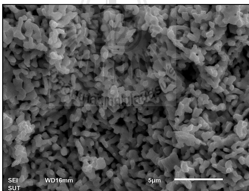
รูปที่ 4.39 โครงสร้างจุลภาคของสารประกอบ \text{La}_{3.95}\text{Sr}_{0.05}\text{Ni}_{2.90}\text{Fe}_{0.10}\text{O}_{10\pm\delta}
