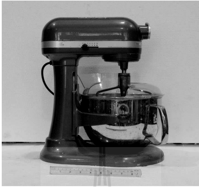
รูปที่ 3.3 เครื่องผสมพร้อมใบกวน (รุ่น 6QT 575W) สำหรับกวนส่วนผสมให้เข้ากัน
