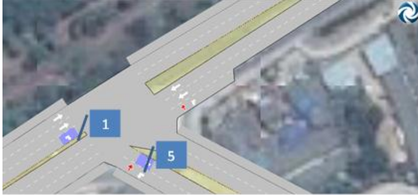
รูปที่ 3.10 ตำแหน่งการติดตั้ง ตัวตรวจนับในแบบจำลองสัญญาณไฟที่สี่กระตุ้น
