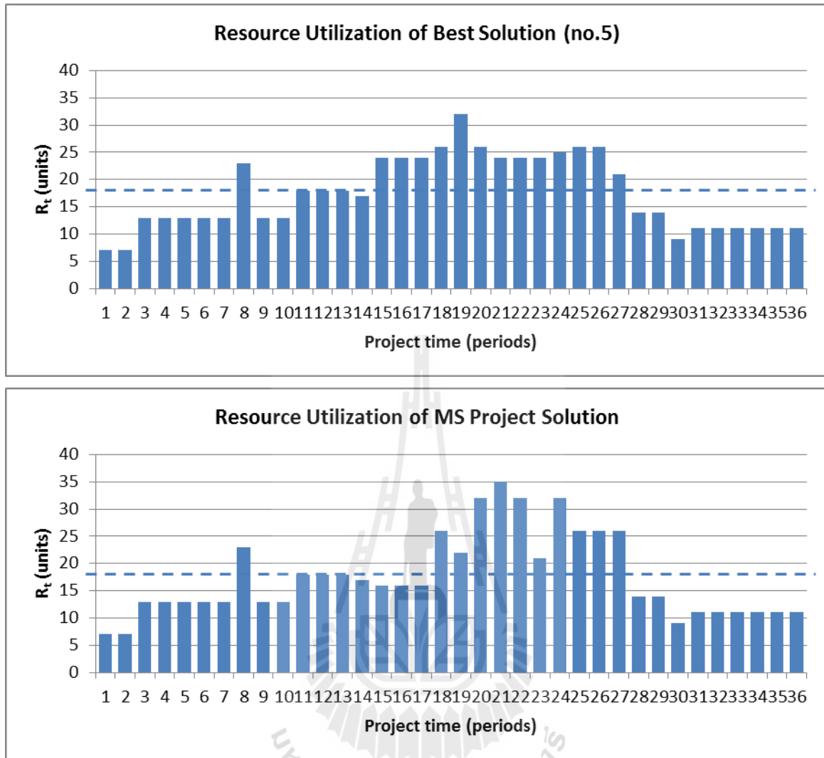
รูปที่ 3.28 การเปรียบเทียบแผนภูมิแท่งของระดับการใช้ทรัพยากรของโจทย์ขนาดใหญ่จากการปรับสมดุลด้วยแบบจำลองที่ไม่มีทางเลือกและโปรแกรมสำเร็จรูป
