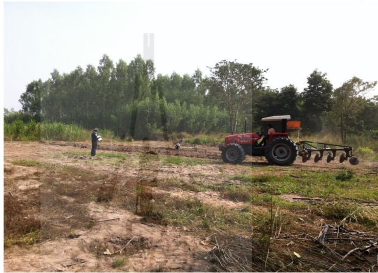
รูปที่ 4.3 การทดสอบไถงานในแปลงทดสอบที่เป็นดินทราย
