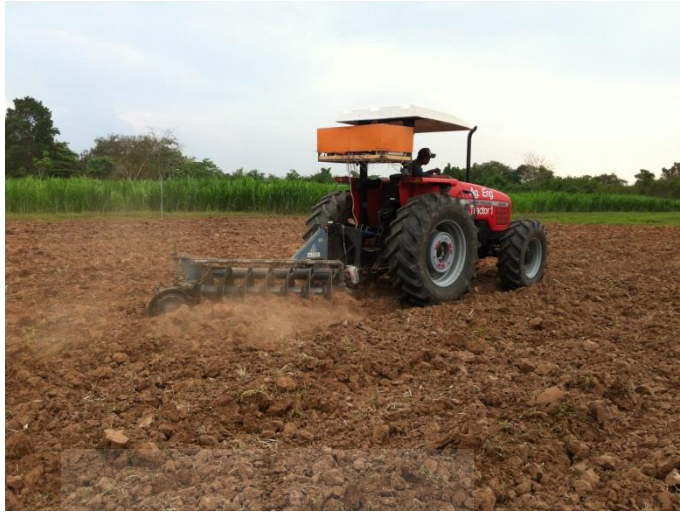
รูปที่ 4.11 การทดสอบไถพรวนงานในแปลงทดสอบที่มีดินร่วนปนทราย
