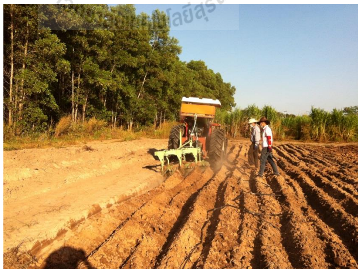
รูปที่ 4.4 การทดสอบไถหัวหมูในแปลงทดสอบที่เป็นดินทราย
