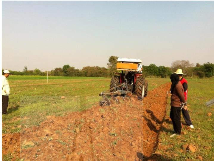
รูปที่ 4.9 การทดสอบไถงานในแปลงทดสอบที่มีดินร่วนปนทราย
