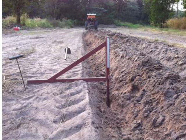
รูปที่ 3.7 เครื่องมือวัดความลึกของร่องไถ
