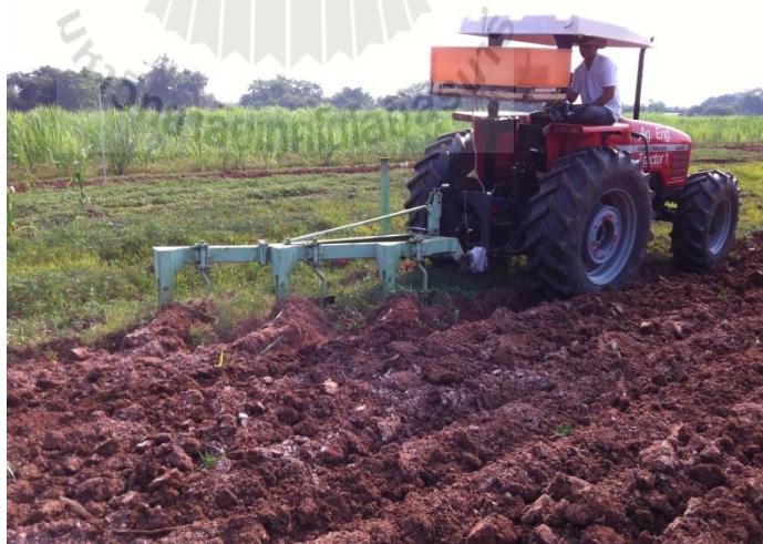
รูปที่ 4.10 การทดสอบไถหัวหมูในแปลงทดสอบที่มีดินร่วนปนทราย
