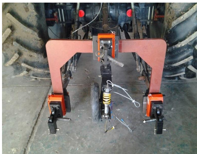
รูปที่ 4.1 การติดตั้งเครื่องมือวัดแรงฉุดลาก
