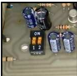
รูปที่.4.18 Dip Switch สำหรับเลือกความถี่ของตัวตรวจวัดยานพาหนะ
