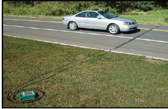
รูปที่.2.12 การตรวจวัดยานพาหนะโดยใช้ท่อลม
