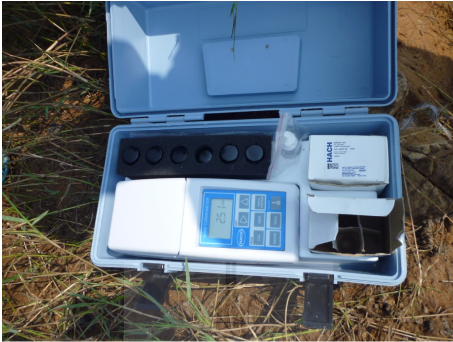
รูปที่ ง-1 เครื่องวิเคราะห์ค่าความขุ่นภาคสนาม
