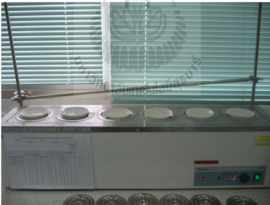
รูปที่ ง-4 การวิเคราะห์ของแข็งทั้งหมดโดยใช้เครื่องอังน้ำ
