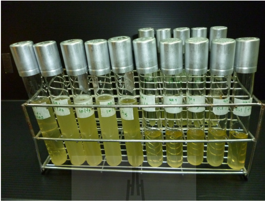
รูปที่ ง-5 การวิเคราะห์แบคทีเรียในน้ำเสียด้วยวิธี Multiple Tube Fermentation Technique
