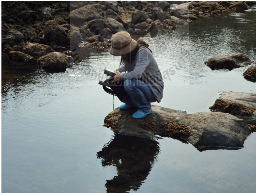
รูปที่ ง-2 การวิเคราะห์ค่าออกซิเจนละลายภาคสนามด้วยเครื่อง Multi probe meter
