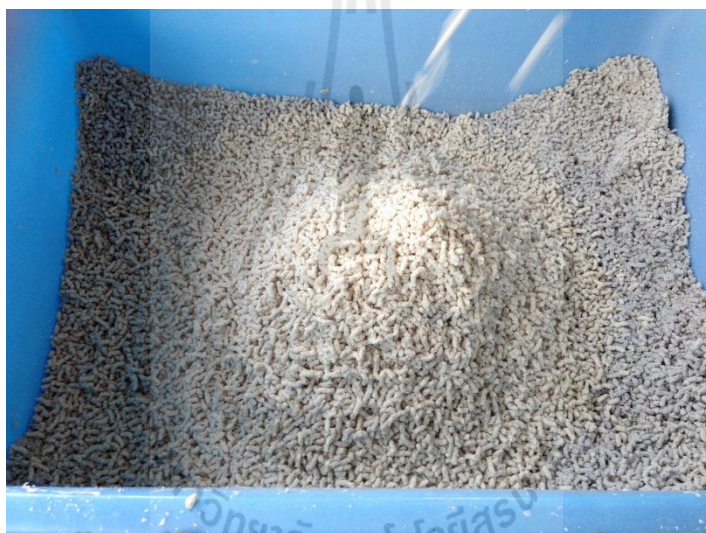
รูปที่ 4-9 ลักษณะของกากมันสำปะหลังที่ผ่านการอัดรีด
