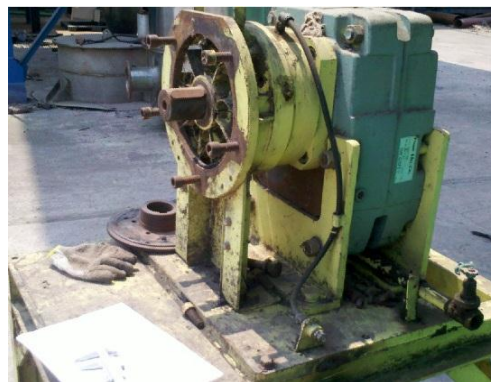
ข) เครื่องอัดแท่งชีวมวลที่ตัดชุดหัวอัดขึ้นรูปออก
