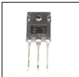
รูปที่ 4.11 ไอจีบีทีที่ใช้ในวงจรแปลงผันแบบชอปเปอร์ทางด้านวงจรสนาม
