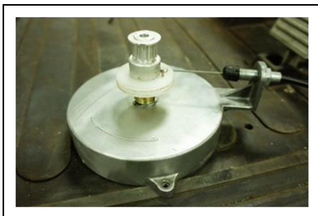
รูปที่ 4.54 ก่อ่งคันเร่งพร้อมจานหมุน
