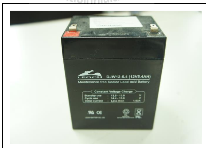
รูปที่ ค.4 แบตเตอรี่ที่ใช้เป็นแหล่งจ่ายของวงจรถูกขนวนเกท
