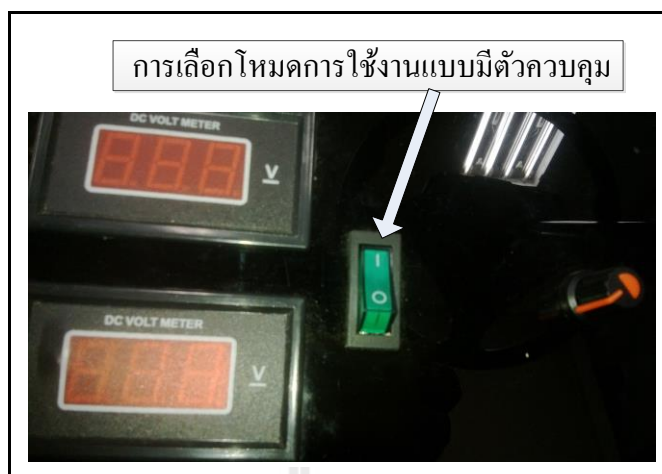
รูปที่ ข.4 สวิตซ์ที่ใช้เลือกโหมดการใช้งานแบบมีตัวควบคุม
