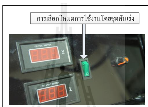
รูปที่ ข.1 สวิตซ์ที่ใช้เลือกโหมดใช้งานคันเร่ง
