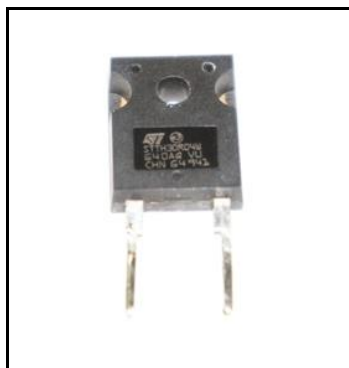
รูปที่ 4.13 ไดโอดที่ใช้ในวงจรแปลงผันแบบชอปเปอร์ทางด้านวงจรสนาม
