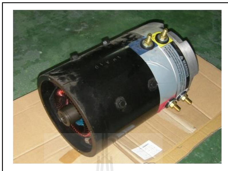
รูปที่ 2.2 มอเตอร์ไฟฟ้ากระแสตรงชนิดแยกกระตุ้นที่ใช้ในงานวิจัย
